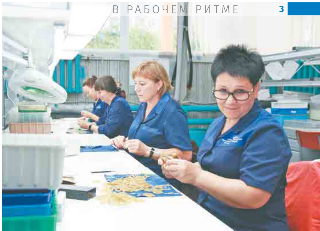
Участок зачистки изделий из пластмасс.
