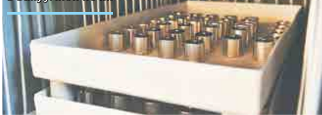
Детали после отжига в вакуумной печи.
